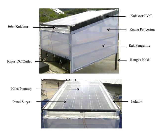
Gambar 2. Perangkat pengering surva PV/T tipe rak
